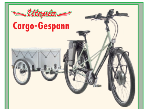
Utopia Cargo und Kranich mit Anhänger haben ein zulässiges Gesamtgewicht von 300kg. Das kommt, weil der Anhänger durch seine Auflaufbremse die eigene Beladung voll abbremsen kann.
