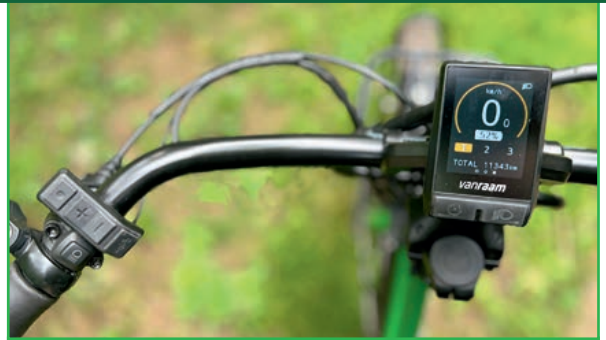
Das neue Display mit vielen Funktionen. Die Funktionen, die man während der Fahrt benutzen soll, sind direkt neben den Griffen.
